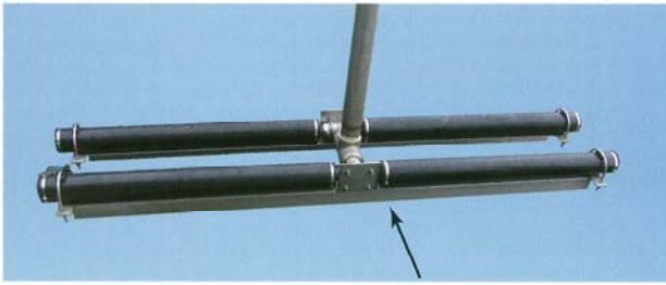
サポート・補強が必要 ※エレメント寸法が762mm以上の場合
